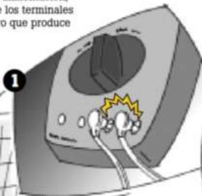
Luego fluye una alta corriente por el circuito cerrado que se forma. En las puntas de la sonda aparece un arco.
