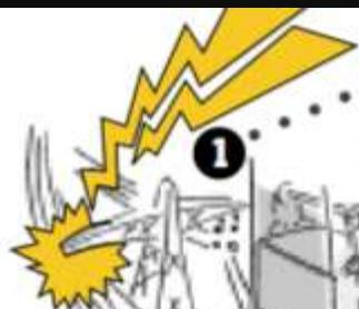
La caída de un rayo genera un transitorio en la línea de alimentación, lo que crea un arco entre los terminales de entrada del multímetro que produce un fuerte ruido.
